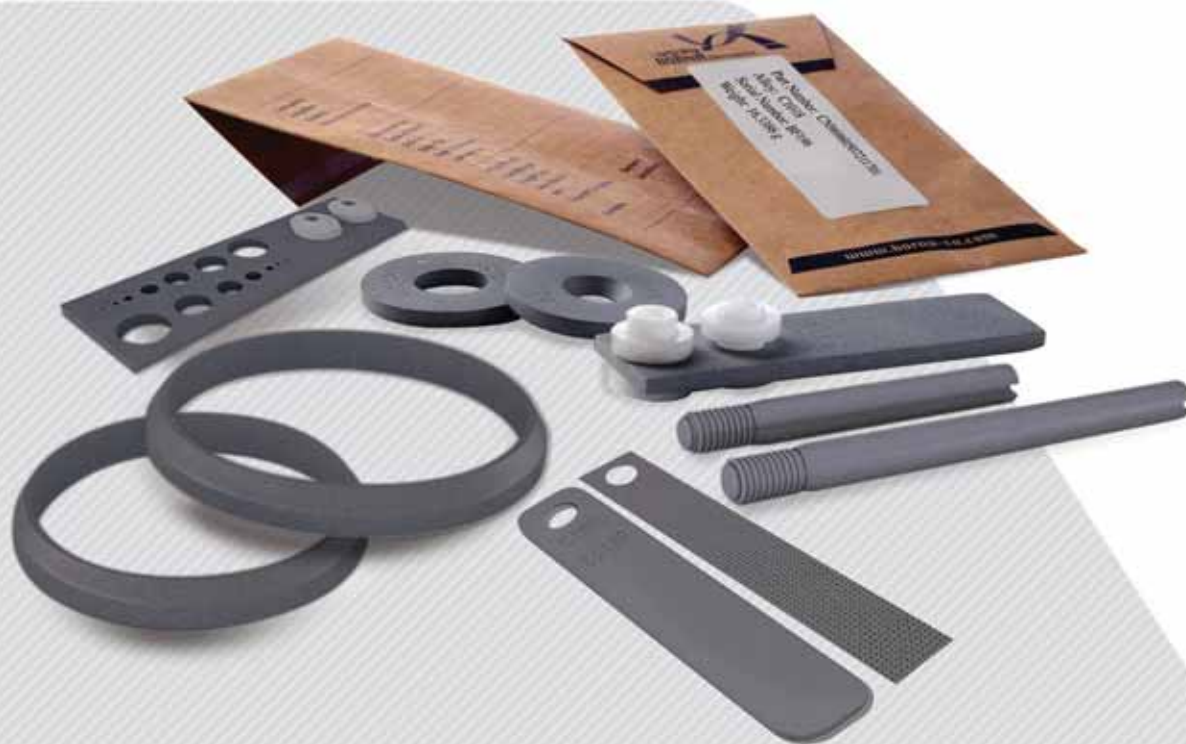
شعاعک کوپن های نصب شده در ساعانه پایشی
